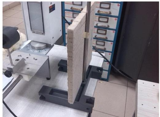
Figura 3.37 Elementos de sujeción de muestras para prueba de reflectividad.
