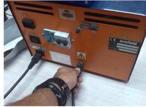
Figura 3.25 Conexión de la fuente de luz en el equipo HT10X.
