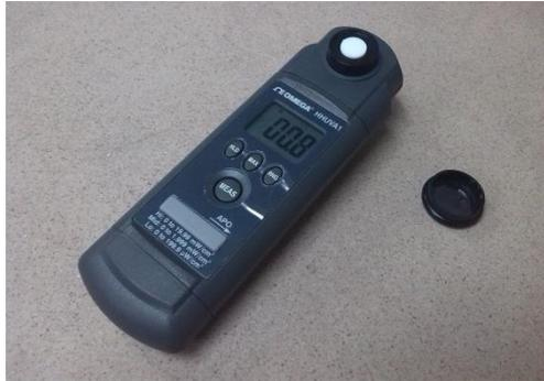
Figura 3.28 Equipo medidor de rayos UV.
