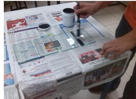
Figura 3.6 Aplicando pintura negra en muestra de vidrio.
