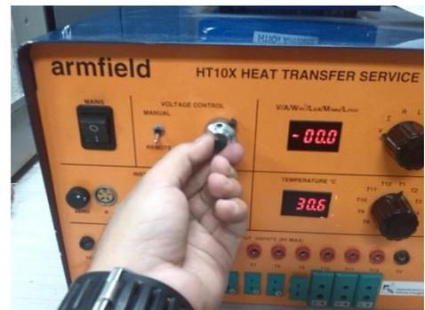
Figura 3.27 Potenciómetro variador de voltaje del equipo HT10X.
