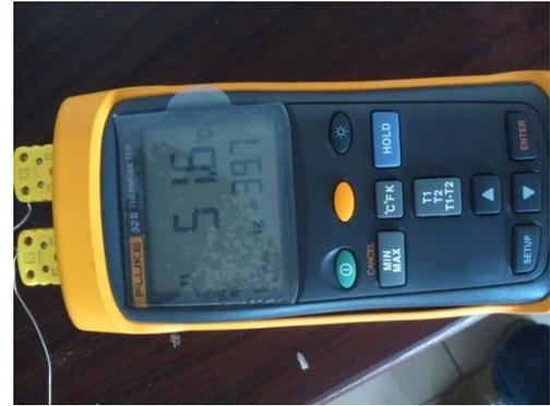
Figura 3.47 Termómetro fluke 51/52 II.
