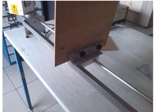
Figura 3.36 Pieza de superficie opaca montada sobre soporte móvil intermedio.
