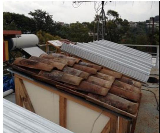
Figura 5.4 Instalación de tejas sobre lámina metálica ondulada.
