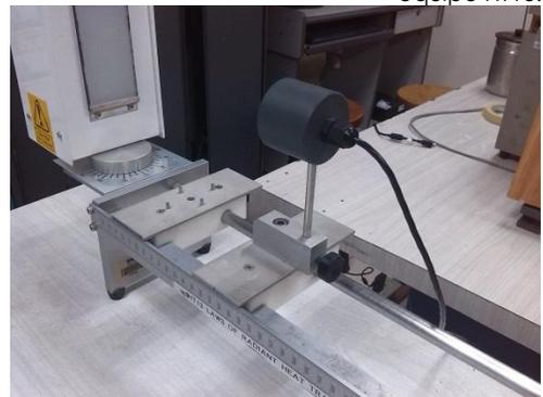
Figura 3.21 Receptor de luz visible montado sobre riel HT13.
