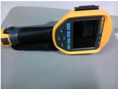
Figura 3.46 Cámara termografica fluke it200.
