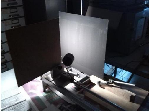
Figura 3.39 Rayos de luz reflejados por la muestra al medidor.
