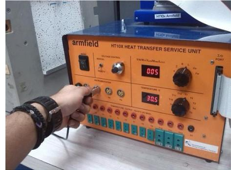
Figura 3.26 Conexión del receptor de luz en el equipo HT10X.
