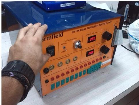
Figura 3.17 Interruptor de encendido Armfield.
