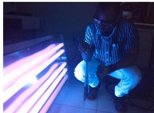
Figura 3.33 Ubicación de la muestra para medir transmisión de rayos UV.
