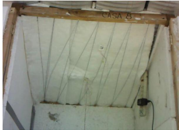
Figura 5.6 Instalación de fibra cerámica en techo metálico auto-soportante.
